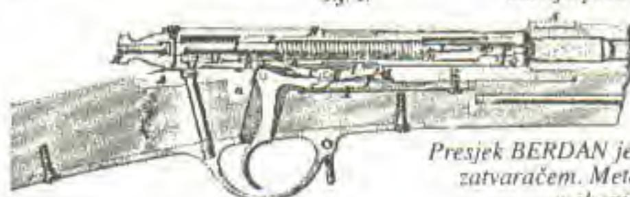
*Presjek BERDAN jednometke sa zatvorenim zatvaračem. Metak je u cijevi i udarni mehanizam je zapet*
